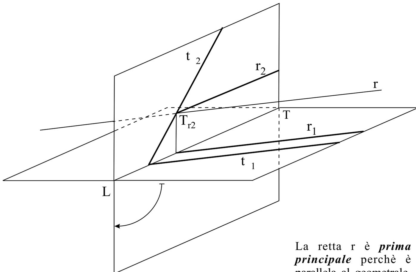
La retta  $r$  è *prima principale* perchè è parallela al geometrico, appartiene al piano dato e la sua prima proiezione  $r_1$  è parallela alla traccia  $t_1$  del piano stesso sul geometrico
