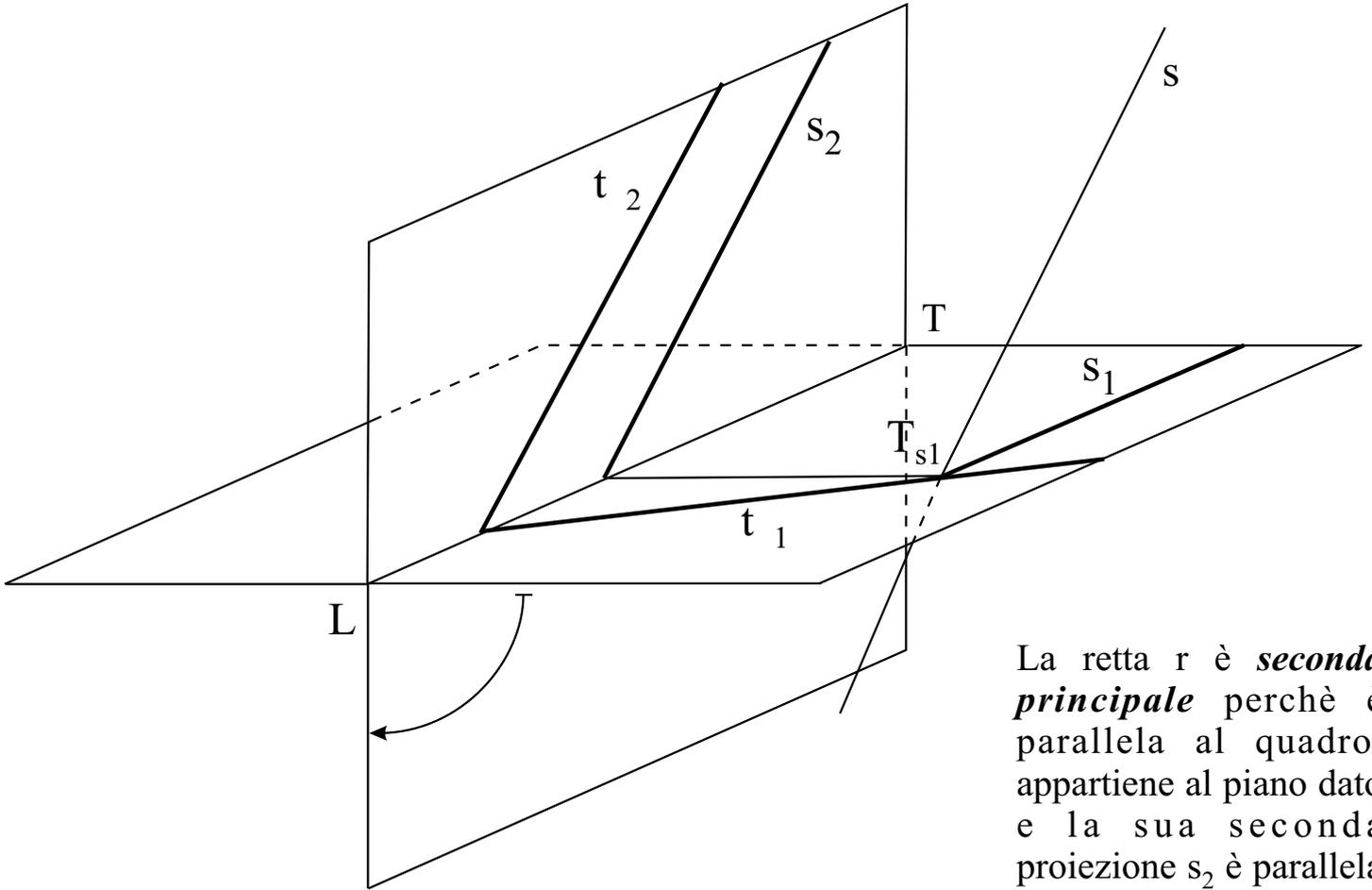
La retta  $r$  è *seconda principale* perchè è parallela al quadro, appartiene al piano dato e la sua seconda proiezione  $s_2$  è parallela alla traccia  $t_2$  del piano stesso sul quadro
