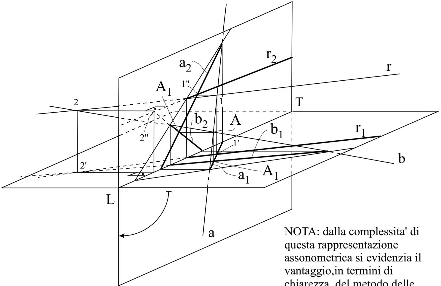
NOTA: dalla complessita' di questa rappresentazione assonometrica si evidenzia il vantaggio, in termini di chiarezza, del metodo delle proiezioni ortogonali per rappresentare con semplicita' enti geometrici variamente posizionati nello spazio
