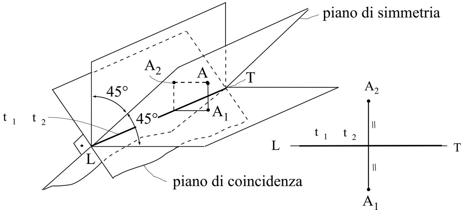
Un punto appartiene ad un piano passante per la linea di terra quando la terza proiezione del punto stesso giace sulla terza traccia del piano:
