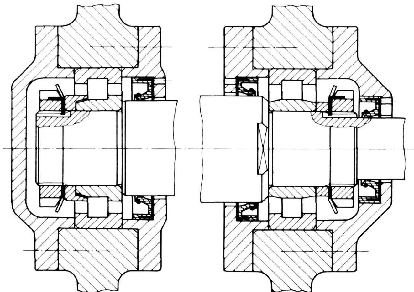
Esempio di montaggio adatto a condizioni di carico assiale limitato e per velocità elevate.
