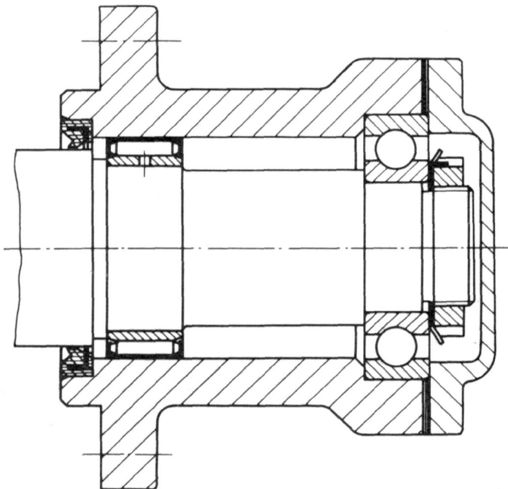
Montaggio di guscio a rullini assieme ad un cuscinetto radiale rigido ad una corona di sfere che assicura il posizionamento assiale.
