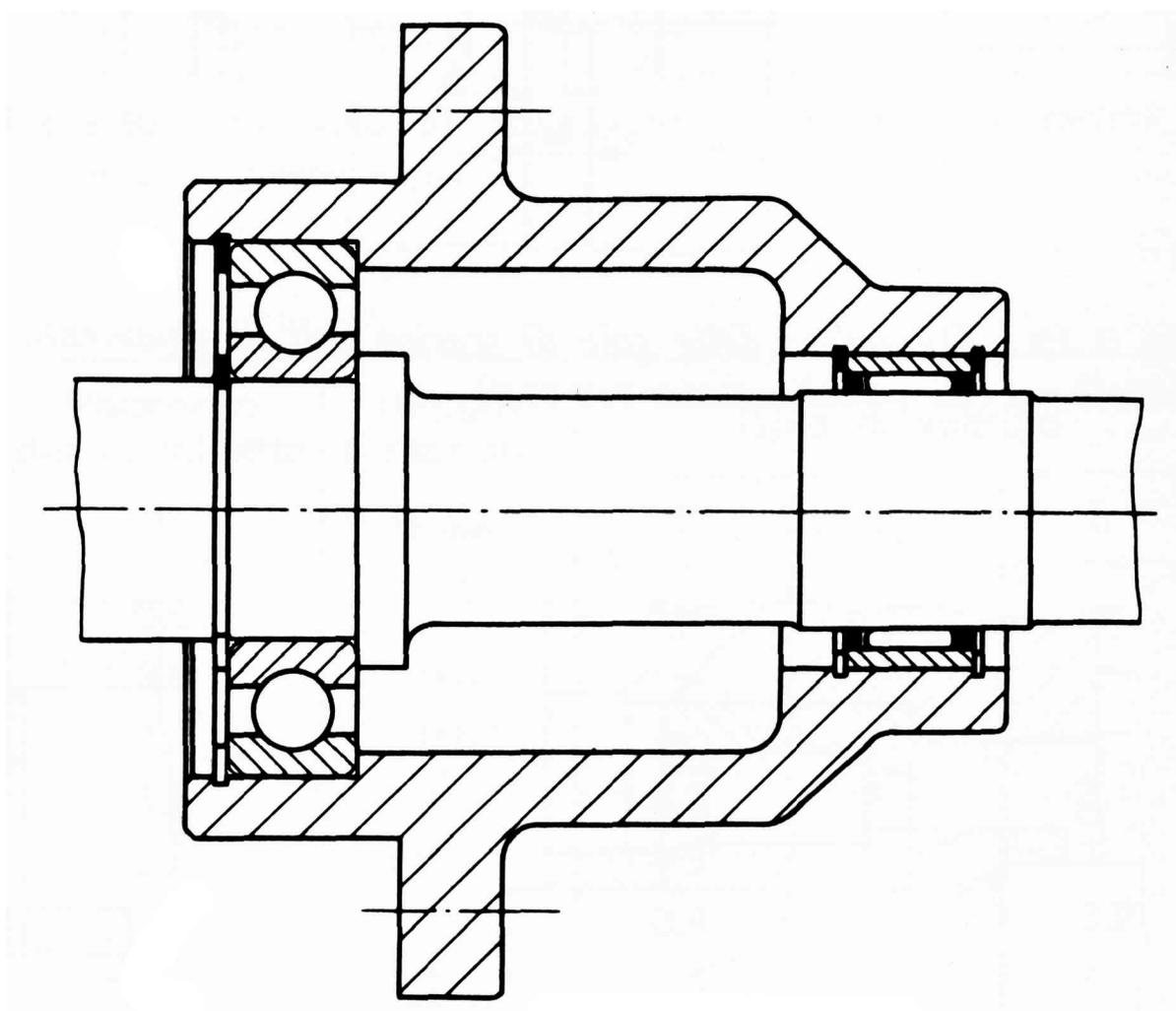
Montaggio di un cuscinetto a rullini senza anello interno e di un cuscinetto radiale rigido a sfere che assicura il posizionamento assiale.
