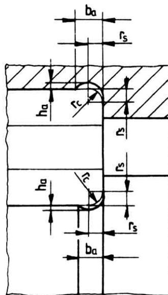
Quotatura delle gole di scarico nell'alloggiamento e sull'albero (da pubblicazione RIV-SKF).
