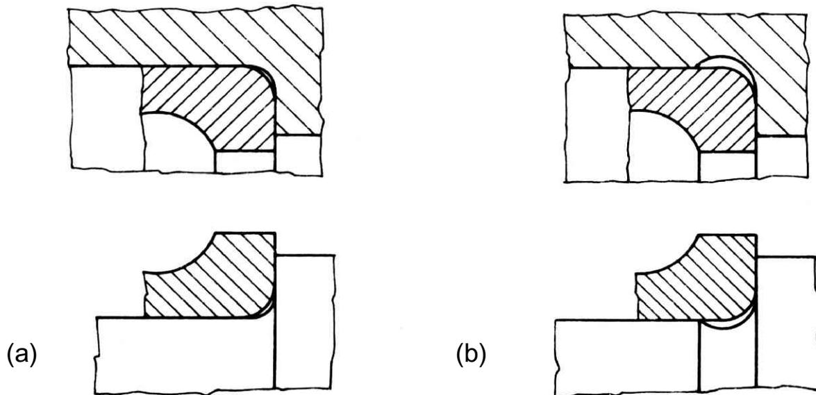
Il passaggio dalla sede cilindrica allo spallamento può avvenire: a) mediante raccordo; b) mediante gola di scarico. In entrambi i casi il raccordo deve consentire l'appoggio degli anelli agli spallamenti.
