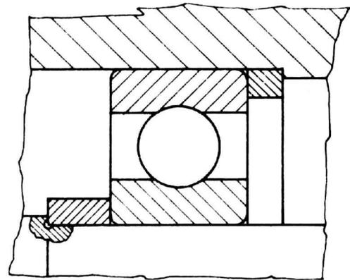
Se l' altezza dello spallamento non è sufficiente si riporta un anello ausiliario a spigoli vivi.
