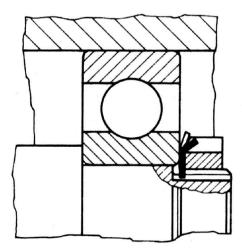
Fissaggio dell' anello interno del cuscinetto mediante ghiera filettata e rosetta di sicurezza.
