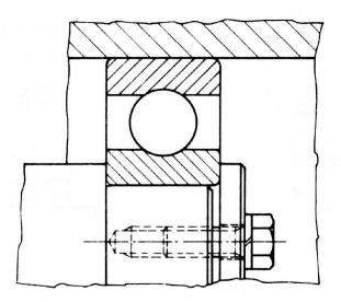
Fissaggio dell'anello interno mediante disco di fermo, vite mordente e rosetta elastica.
