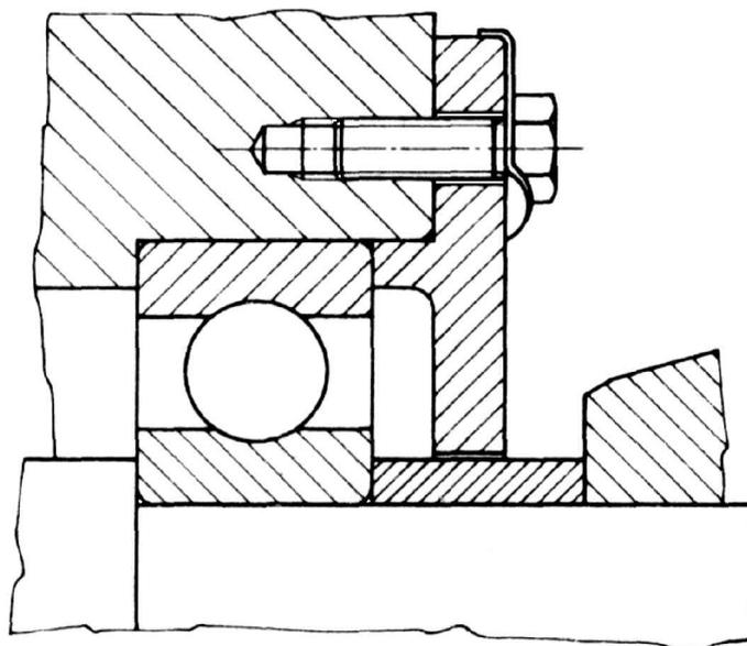
Fissaggio assiale dei due anelli del cuscinetto. L' anello esterno è fissato tramite coperchio d' estremità mentre l' anello interno è fissato con l' uso di un distanziale.
