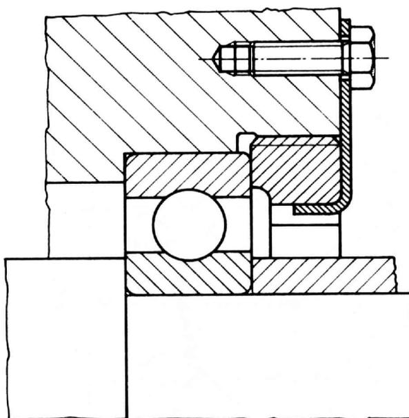
Il fissaggio dell' anello esterno del cuscinetto è ottenuto con un anello filettato la cui rotazione è impedita da una rosetta di sicurezza con nasello ripiegato in una tacca dell' anello stesso.
