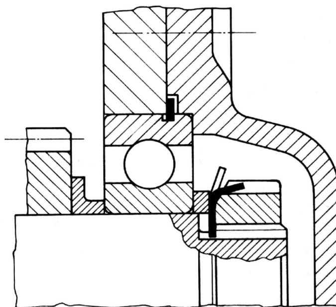
Un cuscinetto con scanalatura ed anello elastico permette una soluzione semplice del fissaggio assiale dell'anello esterno.
