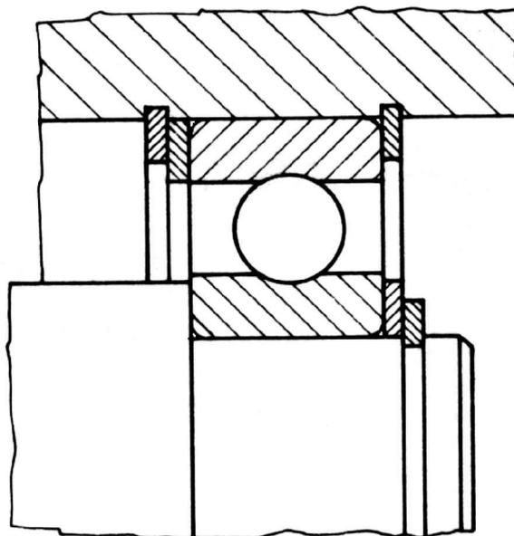
Impiego di anelli elastici di sicurezza per il fissaggio assiale degli anelli di un cuscinetto, con l'interposizione di anelli distanziatori.
