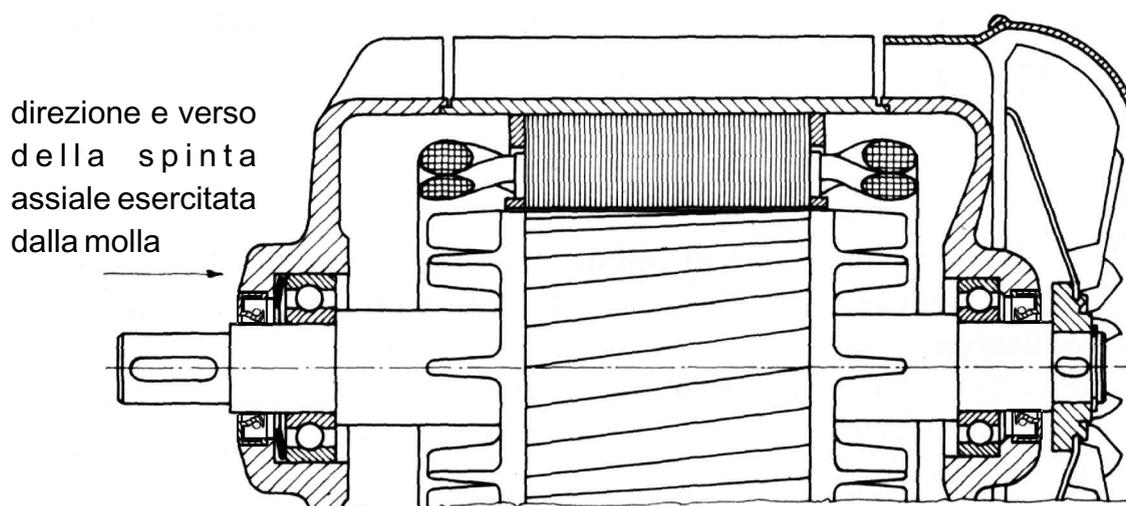
Montaggio di una sola molla a stella su motore elettrico.
