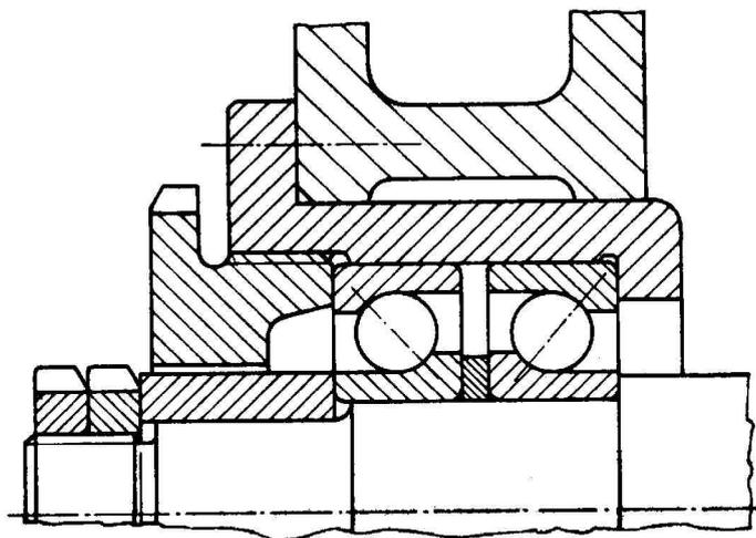
Regolazione del gioco in una coppia di cuscinetti radiali obliqui ad una corona di sfere per mezzo di una ghiera di registrazione (montaggio ad "X") che agisce sull' anello esterno. La regolazione deve essere fatta per gradi, cioè facendo seguire ad ogni registrazione una corsa di prova dei cuscinetti per controllare la temperatura.
