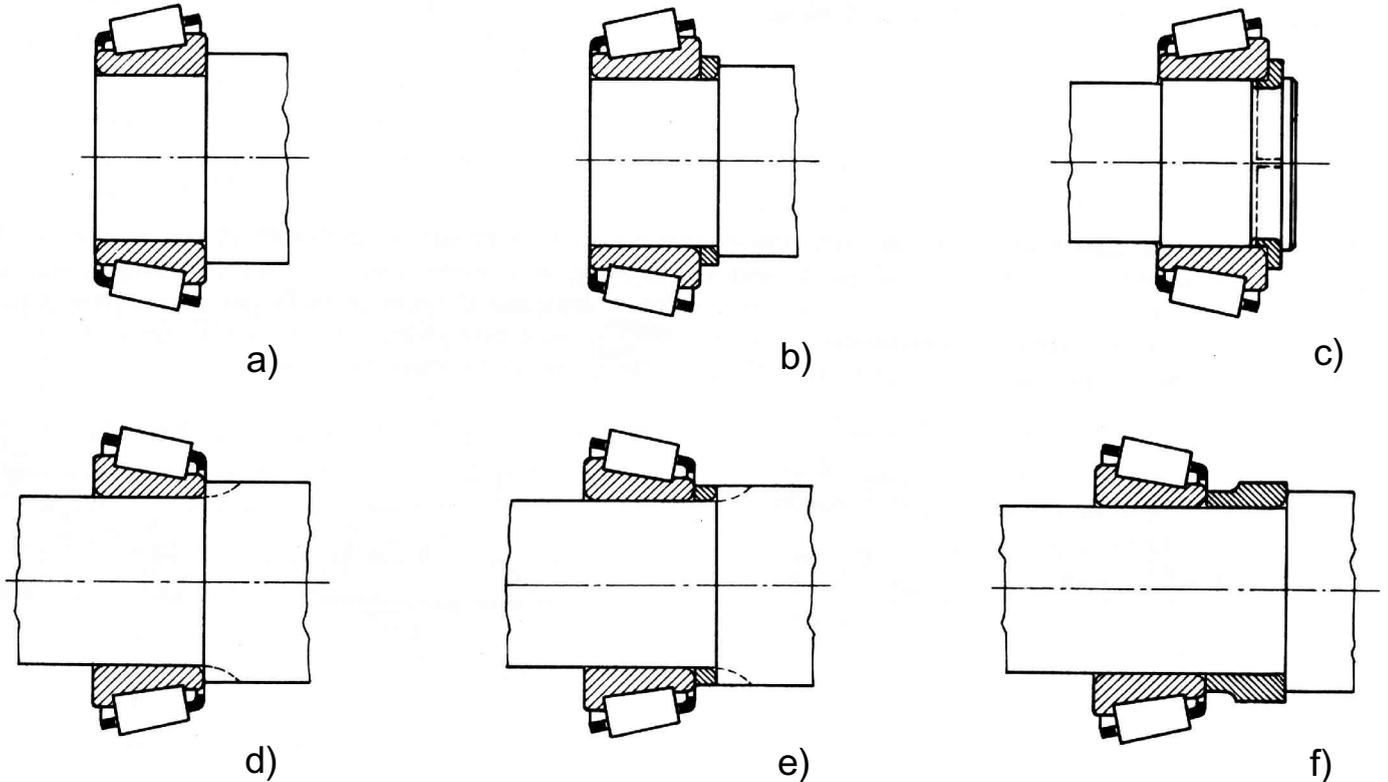
Esempi di spallamenti per il cono dei cuscinetti a rulli conici; a) normale tipo di spallamento; b) anello in caso di spallamento insufficiente; c) il cono è montato alla pressa: l'anello di spallamento in due metà 10° tiene in posizione; d) fresature previste per l'impiego di un estrattore; e) anello di spallamento riportato e fresature per estrattore; f) anello di spallamento riportato che evita le fresature per l'estrattore (da pubblicazione TIMKEN).
