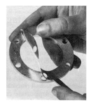
Preparazione di uno spessore ALTHERMILL mediante pelatura. Questi spessori sono ottenuti dalla sovrapposizione di fogli singoli di spessore 0,05-0,076-0.1mm, uniti per mezzo di incollaggio a base di resina se sono in alluminio o in acciaio inossidabile, oppure per mezzo di saldatura allo stagno quando sono in ottone o acciaio dolce. Sono fornibili secondo forme, dimensioni e tolleranze richieste.
