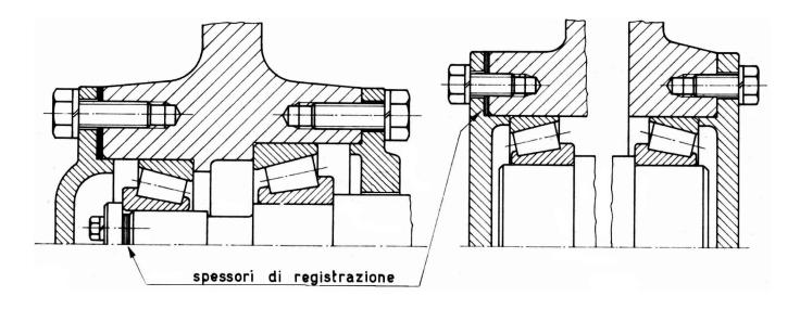
Esempi di registrazione di cuscinetti a rulli conici mediante spessori calibrati. La registrazione avviene per gradi.
