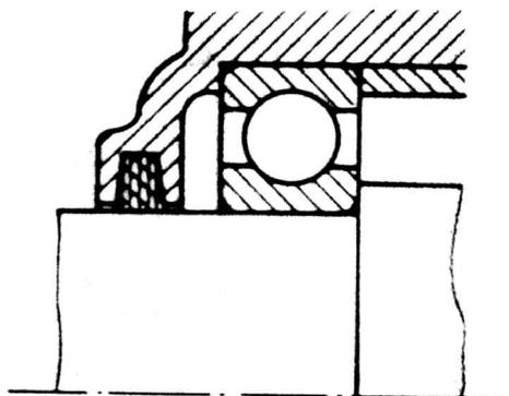
Guarnizioni di feltro per lubrificazione a grasso, per velocità periferica  $V \leq 4$  m/s e  $t \leq 100^\circ\text{C}$ .
