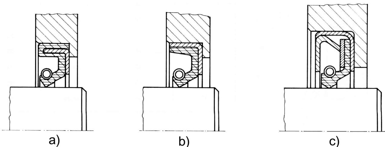
Applicazioni di anelli di tenuta a) di impiego corrente, b) con scatola metallica che conferisce all' anello maggior rigidità, c) con forma del labbro che garantisce elevatissima durata ed efficienza (da catalogo GALLITAL) a condizione che tale parte dell' anello sia sempre lubrificata.
