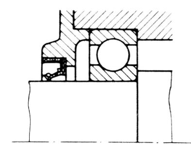
Anello speciale di gomma per lubrificazione ad olio con labbro diretto verso l' <u>esterno</u> per impedire la penetrazione di impurità.
