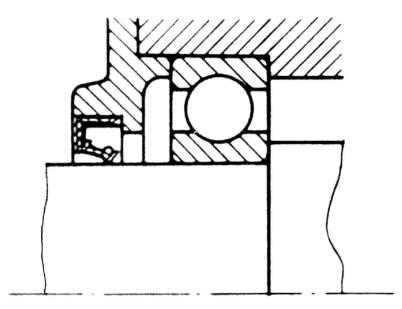
Anello speciale di gomma per lubrificazione ad olio con labbro diretto verso l' interno per impedire l' uscita di lubrificante.
