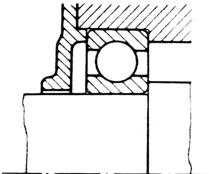
Luce ridotta tra albero e foro: sufficiente per meccanismi che lavorano in ambienti asciutti esenti da polveri.
