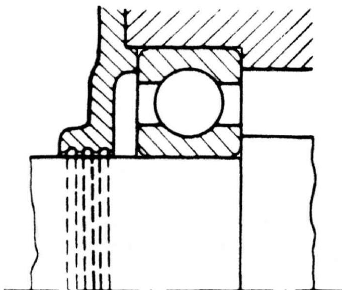
Luce ridotta con scanalature circolari, per lubrificazione a grasso che, tendendo ad uscire riempie le scanalature fungendo da tenuta.
