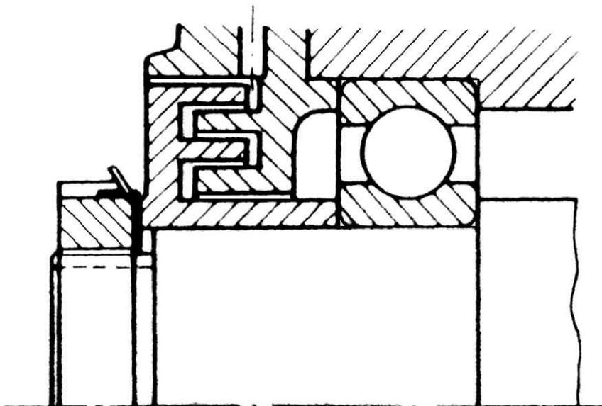
L a b i r i n t o , per lubrificazione a grasso: canali assiali quando l'alloggiamento non è diviso (cioè è composto da due parti simmetriche).
