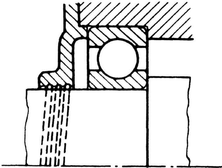
Luce ridotta con scanalatura elicoidale, con elica di verso contrario a quello di rotazione per respingere l'olio verso il cuscinetto.
