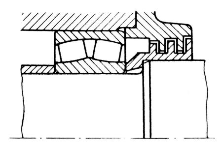
Labirinto, per lubrificazione a grasso: canali radiali quando l' alloggiamento è diviso (cioè è composto da due parti simmetriche).
