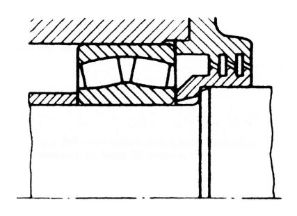
Labirinto, per lubrificazione a grasso: canali inclinati, l'alloggiamento è diviso (cioè è composto da due parti simmetriche). L'albero può inclinarsi sensibilmente (per es. a causa della flessione) senza che si verifichi contatto tra la parte fissa e quella rotante della tenuta.
