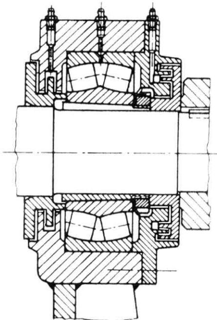
Canale di lubrificazione che sfocia direttamente tra i corpi volventi in un cuscinetto orientabile a due corone di rulli avente fori di lubrificazione sull' anello esterno. Sono indicati anche gli ingrassatori per le tenute a labirinto.
