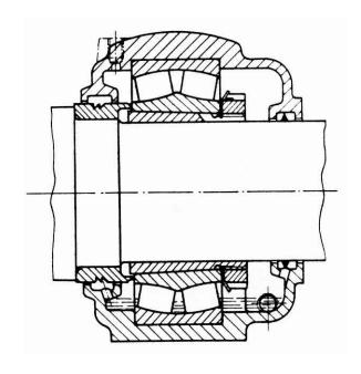
Lubrificazione a bagno d' olio: il livello dell'olio è situato leggermente al disotto del centro del corpo volvente posto nella parte più bassa.
