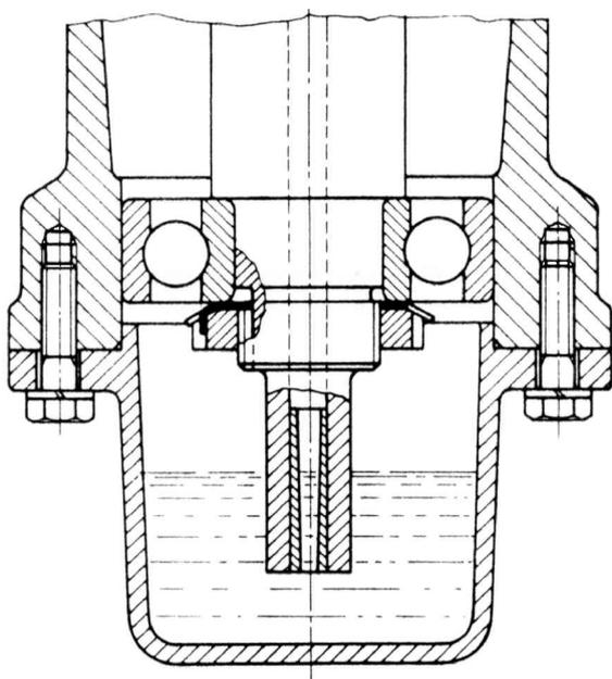
Circolazione dell' olio ottenuta mediante l' effetto pompante dell' inserto conico rotante ad elevata velocità.
