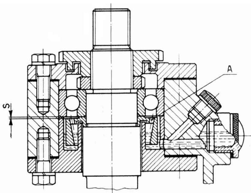
Adduzione dell' olio al cuscinetto mediante ascesa lungo la bussola internamente conica e attraverso i fori A e il gioco S che è compreso tra 0.3 e 0.5 mm per cuscinetti con diametro del foro da 30 a 50 mm.
