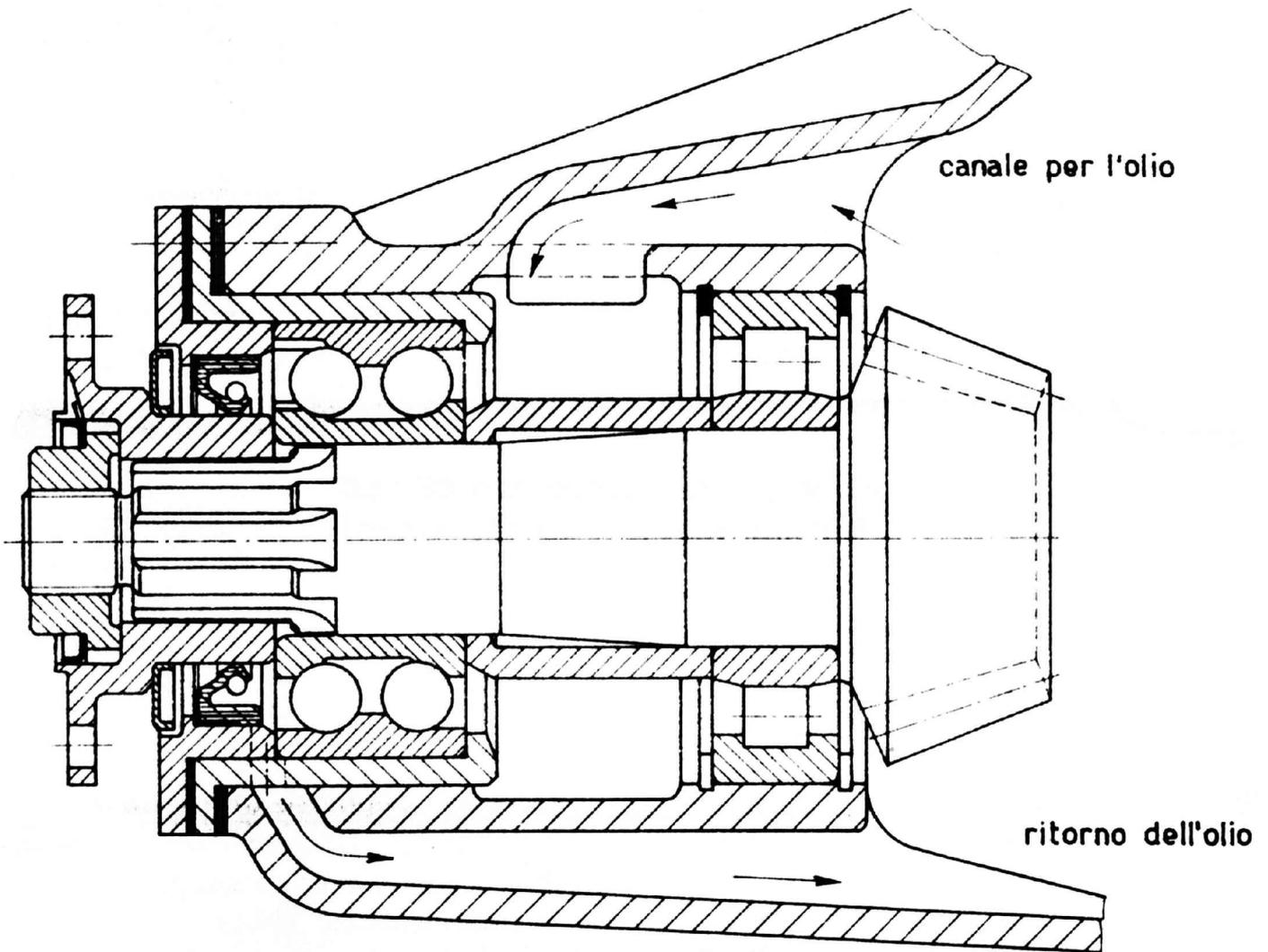
Esempio di pignone conico, per trasmissione d' auto, guidato mediante un cuscinetto radiale obliquo, a due corone di sfere e un cuscinetto radiale, rigido, ad una corona di rulli cilindrici con orletti sull' anello esterno (da pubblicazione FAG).
