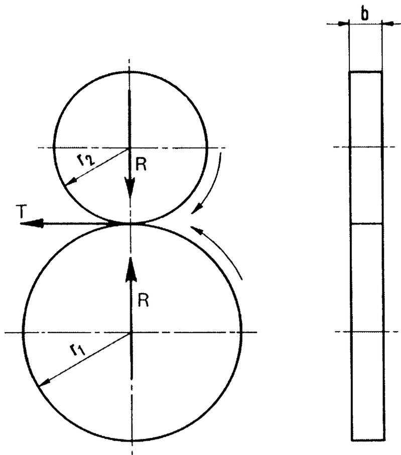
Rappresentazione schematica di ruote di frizione cilindriche.
