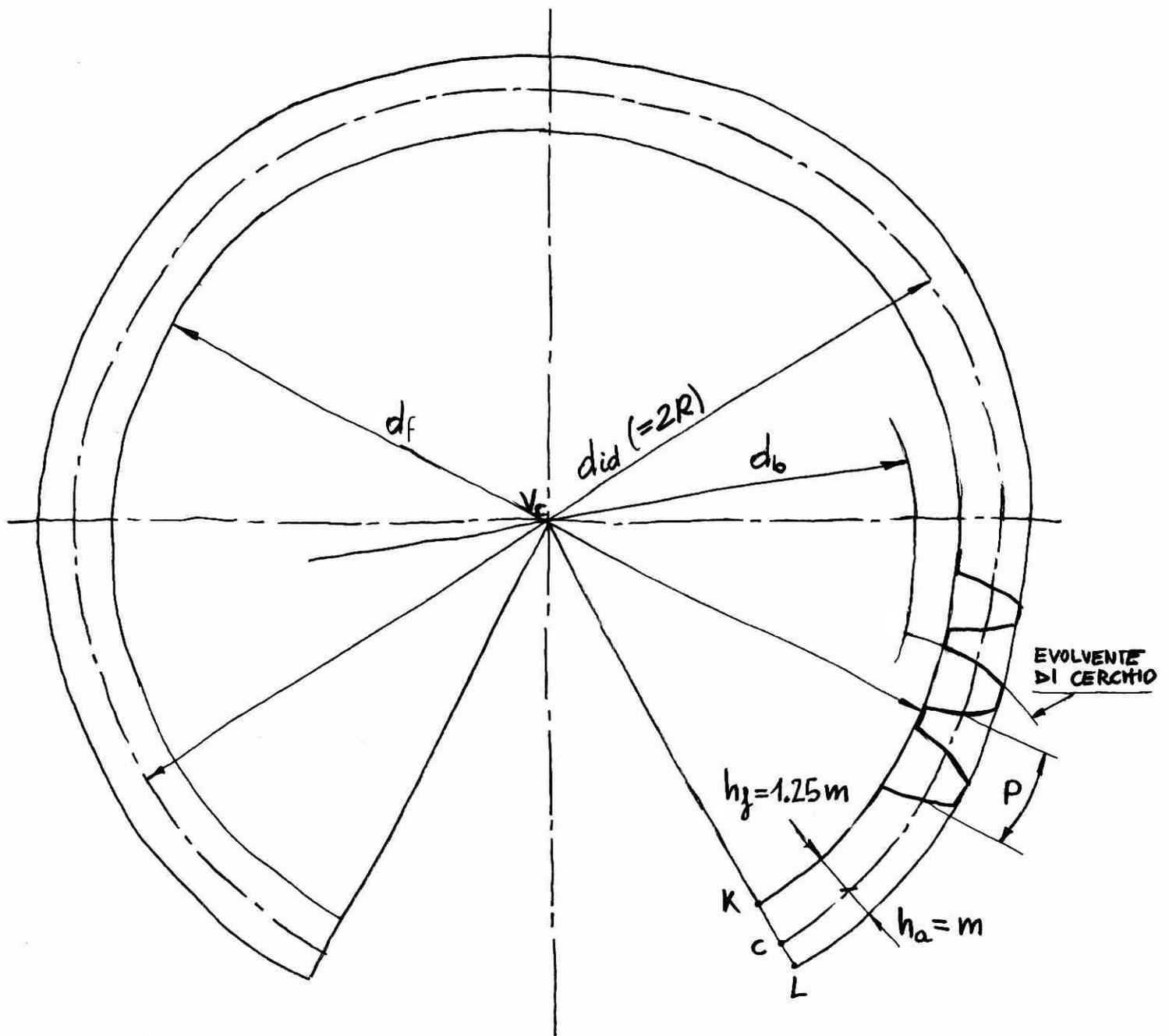
**RUOTA DENTATA IDEALE:** UNA RUOTA DENTATA A DENTI DRITTI SENZA SPESSORE, CON NUMERO DI DENTI NON INTERO E DI ESTENSIONE ANGOLARE INFERIORE A  $360^\circ$
