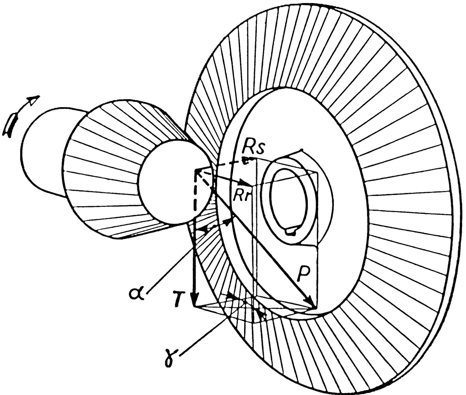
La componente radiale  $R_s$  applicata dal pignone alla ruota di diametro maggiore diviene per quest' ultima una azione esterna di tipo assiale che tende ad allontanarla nella direzione dell' asse di rotazione rispettivo. La reazione assiale  $-R_r$  che il pignone riceve tende analogamente a far traslare lo stesso in verso contrario a  $R_r$
