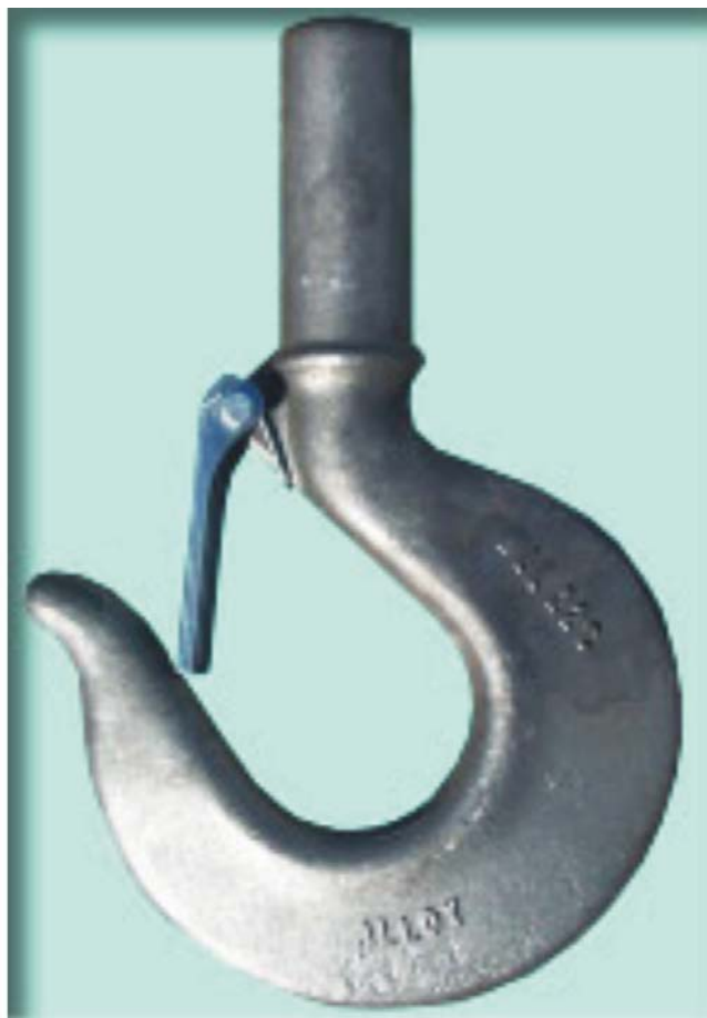
Fig. 3.4 – Due tipi di ganci con gambo grezzo.
