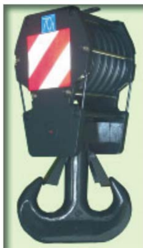
BOZZELLO A SEI CARRUCOLE FUNE \varnothing 20 mm. PORTATA 70 ton.
