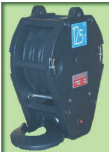
BOZZELLO A TRE CARRUCOLE FUNE \varnothing 12 mm. PORTATA 12,5 ton.
