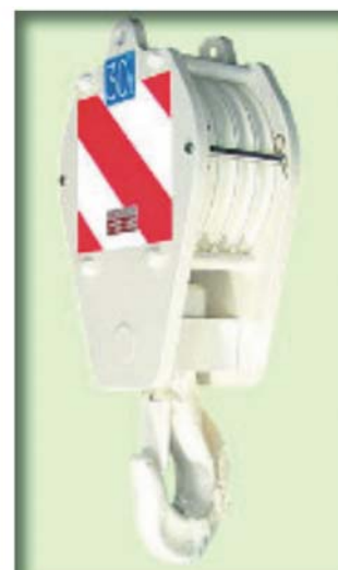
BOZZELLO A QUATTRO CARRUCOLE FUNE \varnothing 15 mm. PORTATA 30 ton.
