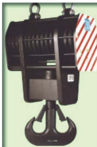
BOZZELLO A TREDICI CARRUCOLE FUNE \varnothing 26 mm. PORTATA 200 ton.
