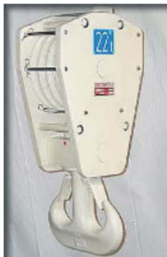
BOZZELLO A QUATTRO CARRUCOLE FUNE \varnothing 14 mm. PORTATA 22 ton.
