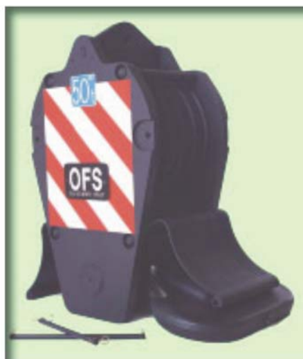
BOZZELLO A SEI CARRUCOLE FUNE \varnothing 16 mm. PORTATA 50 ton.
