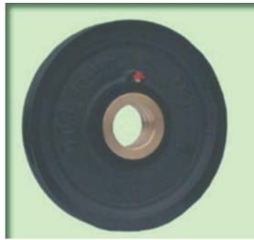
CARRUCOLA LAVORATA E FORNITA CON BOCCOLE FLANGIATE IN BRONZO ED INGRASSATORE A SFERA. ESECUZIONE IN GHISA SFEROIDALE GS 400/12 UNI 4544
