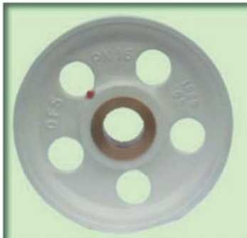
CARRUCOLA LAVORATA E FORNITA CON CUSCINETTO A RULLINI, BOCCOLE FLANGIATE IN BRONZO ED INGRASSATORE A SFERA. ESECUZIONE IN GHISA SFEROIDALE GS 400/12 UNI 4544
