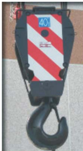
BOZZELLO A CINQUE CARRUCOLE FUNE \varnothing 18 mm. PORTATA 40 ton.
