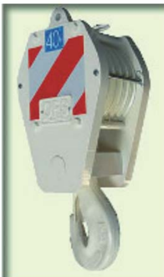
BOZZELLO A CINQUE CARRUCOLE FUNE \varnothing 15 mm. PORTATA 40 ton.
