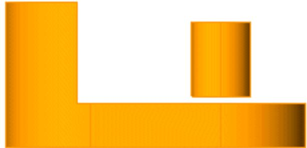
L'aspetto del solido è corretto, ma i due cilindri non toccano il piano.
