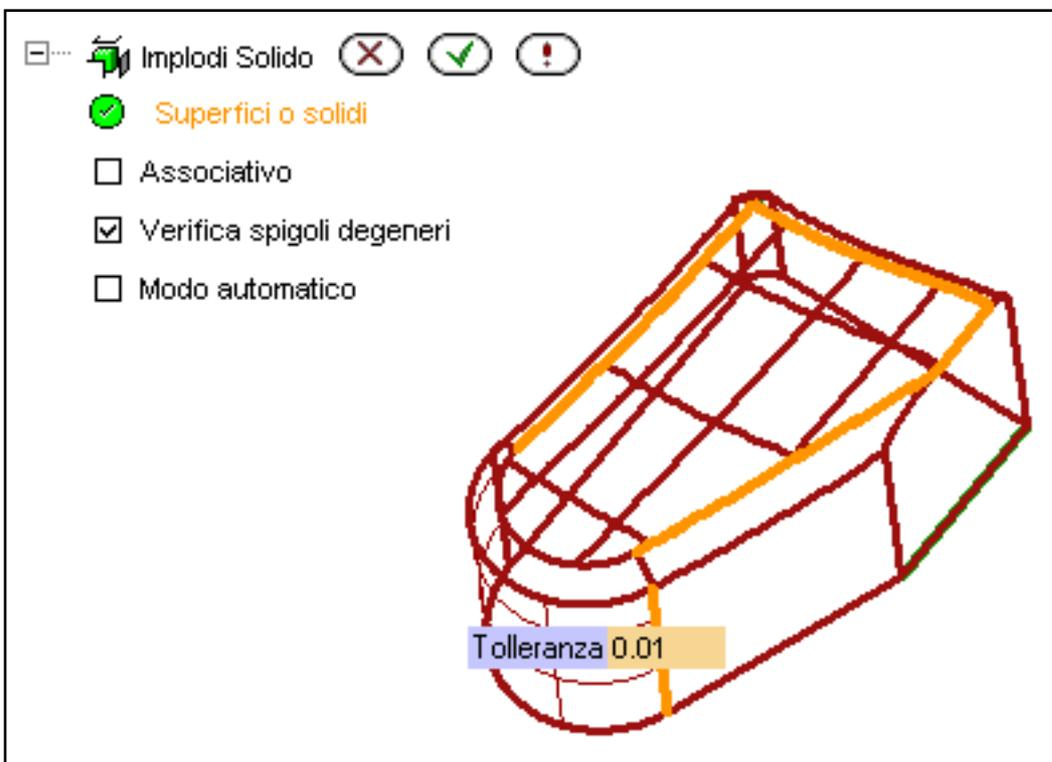
Ciò significa che per qualche ragione devono esistere spigoli degeneri, ovvero spigoli che condividono più di due facce creando una situazione di tipo "non manifold". È possibile individuare facilmente questi spigoli (vedere nel manuale il **Posizionamento di spigoli aperti (non collegati)**).
