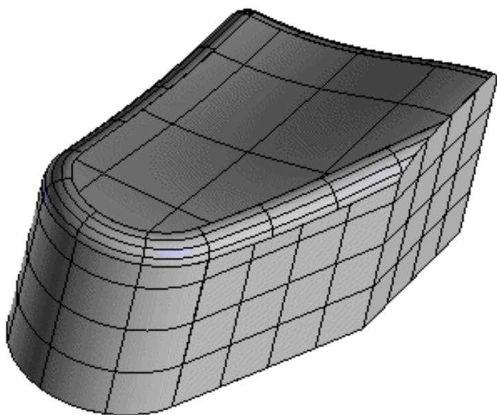
La creazione di un solido con il comando **Implodi solido** consente di ottenere un solido "non chiuso", ovvero non manifold. È possibile evidenziare gli spigoli scollegati.
