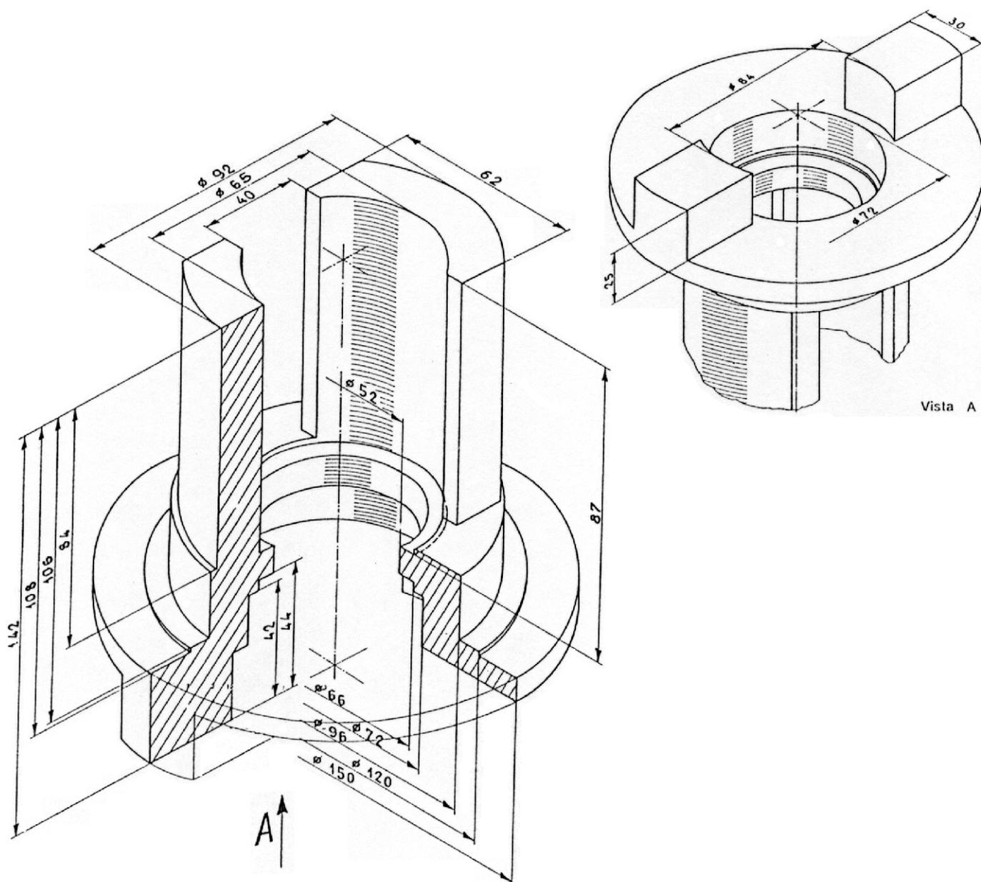
Vista assonometrica di una bussola fresata
