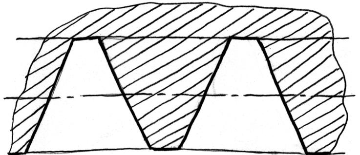
Profilo di esecuzione ottenuto da quello di base con l'aggiunta del raccordo sul fondo del filetto
